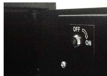
Cerradura que habilita o inhabilita la caja fuerte.
